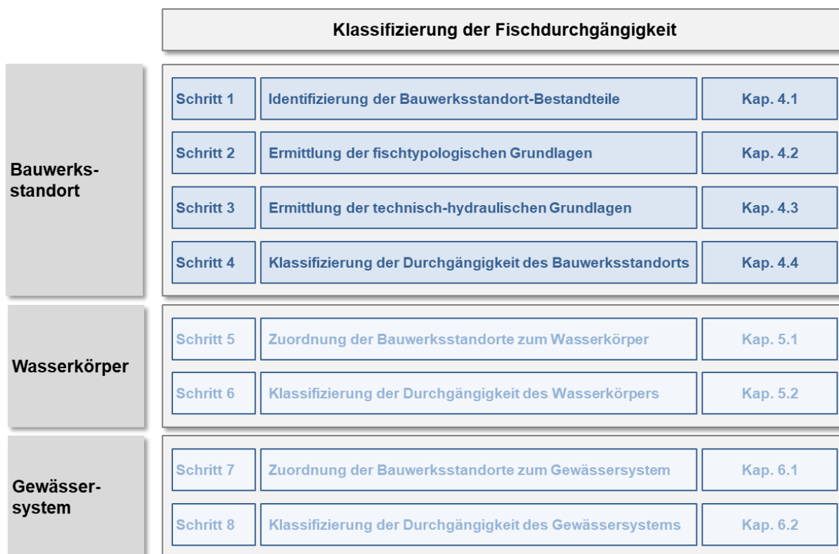
Abbildung 1: Grundlegende Schritte zur Klassifizierung der Durchgängigkeit von Fließgewässern in den drei Betrachtungsebenen Bauwerksstandort, Wasserkörper und Gewässersystem. Für den Bauwerksstandort ist die in der Verfahrensempfehlung vorgeschlagene regelbasierte Klassifizierung dargestellt.
