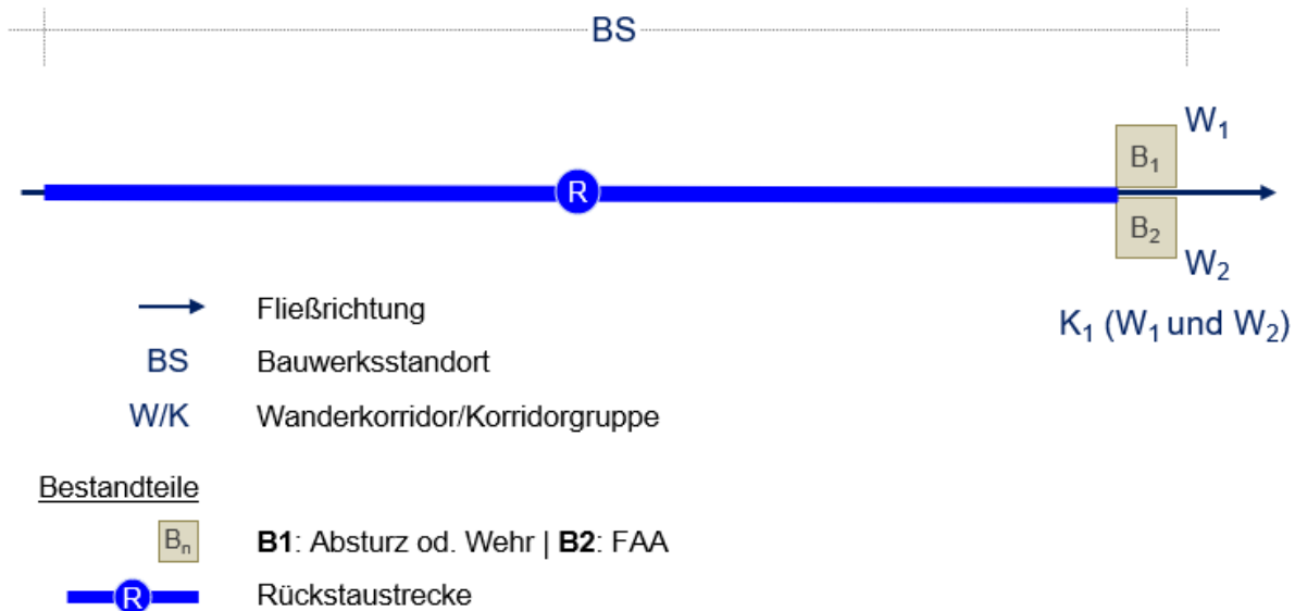
Abbildung 25: Bauwerksstandort bestehend aus drei Bestandteilen (siehe auch Abbildung 26).
